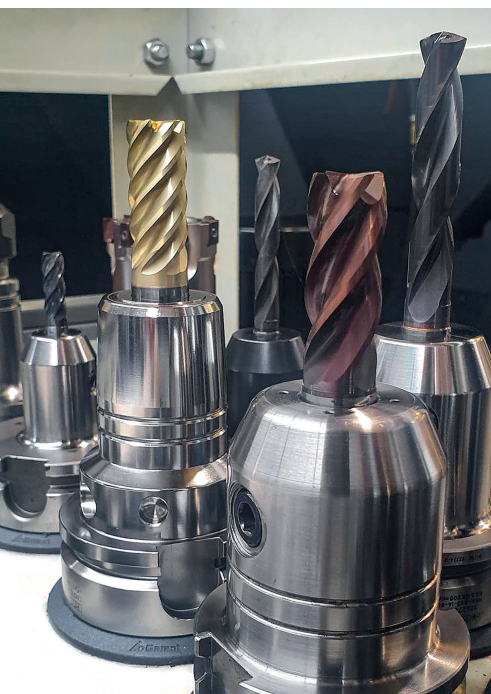
5 Die Fräser 'RF 100 Raptor' (goldfarben) und 'RF 100 VA' (rötlich) gehören neben diversen VHM-Bohrern zu den weiteren Präzisionswerkzeugen, die Hennecke von Gühring bezieht © Gühring
